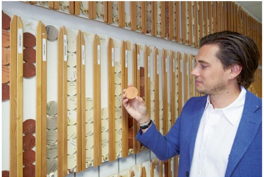
Bild 4 Im „Keksraum“ im Labor werden Tonproben für verschiedenste Rezepte gelagert. Die Färbung der Probe ist ein guter erster Indikator für die Zusammensetzung. (© Frey)
